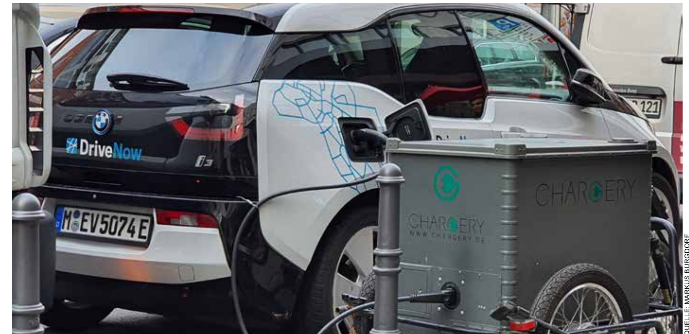
Notauffladung eines BMW i3 von DriveNow mit Hilfe eines Akku-Anhängers.
